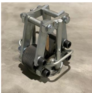
333038 Radklemme Ø 22 - 65 mm Zum Ziehen des Verlängerungsrohrs
